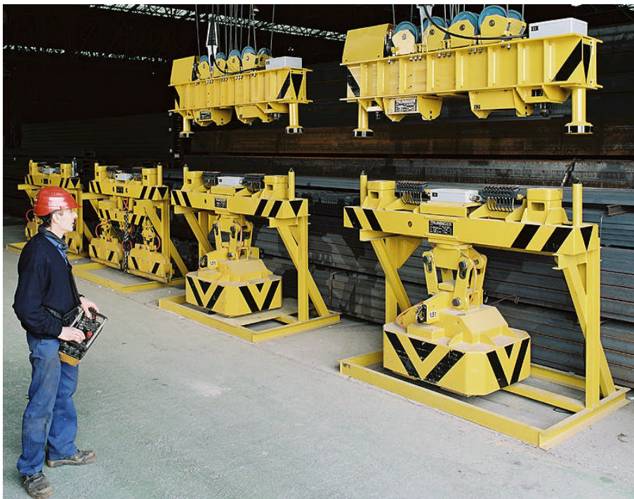
Figure 3: Schnelles Ankoppeln der Trägerbundmagnete zur effizienten und schnellen Entladung von Zügen oder Schiffen
