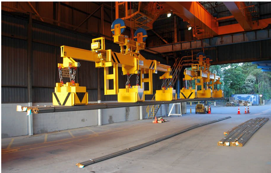
Figure 1: Aktives Teleskop beim Transport von unterschiedlichen Längen von Betonstabstahlbunden
