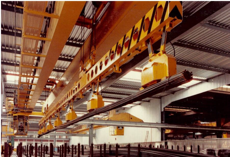
Figure 2: Entnehmen eines Betonstabstahlbundes aus einem Rungenlager
