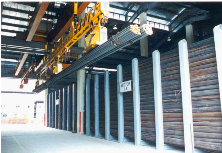
Figure 1: Hohe Lagerdichte im Betonstabstahllager
