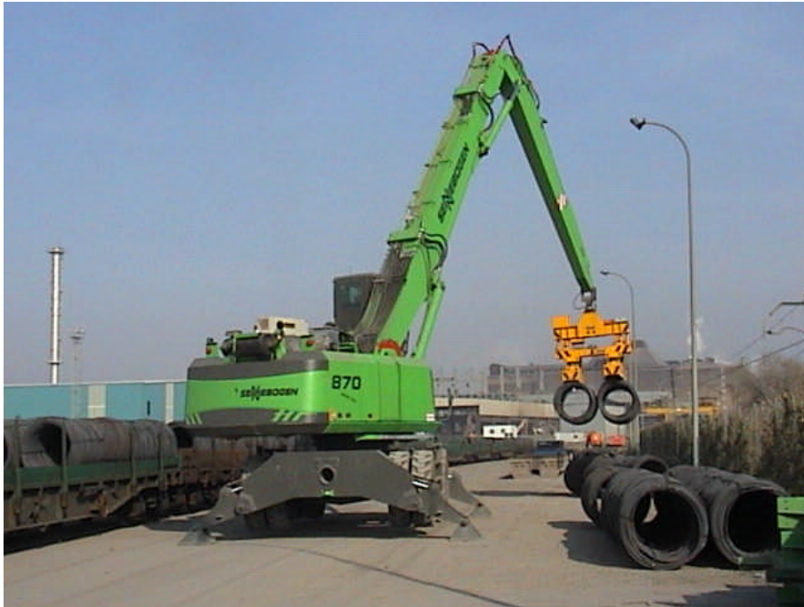
Figure 3: Mobile Magnethebetechnik für schweren Betonstahl-Coil-Transport
