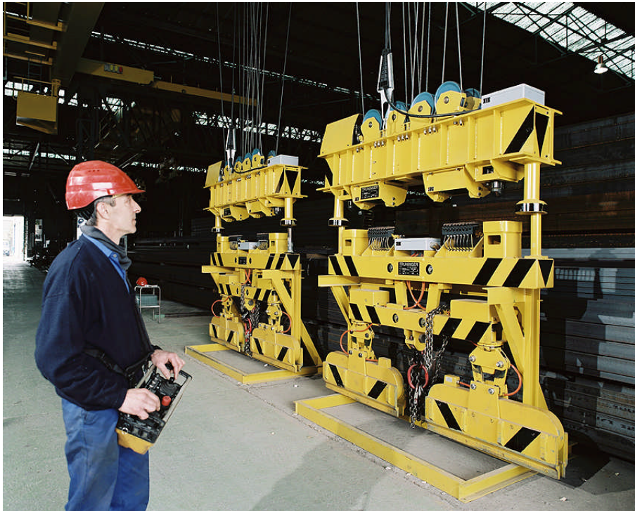
Figure 1: Bediener einer Magnetanlage für Trägertransport
