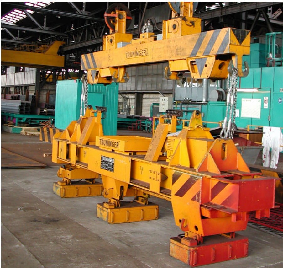
Figure 2: Aktives Teleskop mit Schnellwechselfunktion
