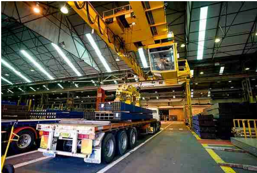
Figure 1: Doppelbundtransport von dünnwandigen Rohrbunden zum effizienten Beladen von Lastwagen bei OneSteel in Australien
