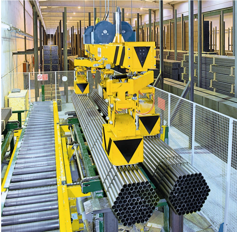
Figure 2: Abräumen des Auslaufes einer Rohrstrasse bei Aratubo in Spanien
