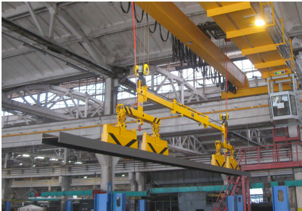
Figure 3: Passives Teleskop mit schmalen Magneten für optimales Trägerhandling
