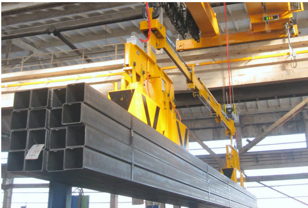
Figure 2: Kraftvolle Magnete für einen sicheren und schnellen Umschlag von Hohlprofilbunden mit der neuen Magnetreihe TM
