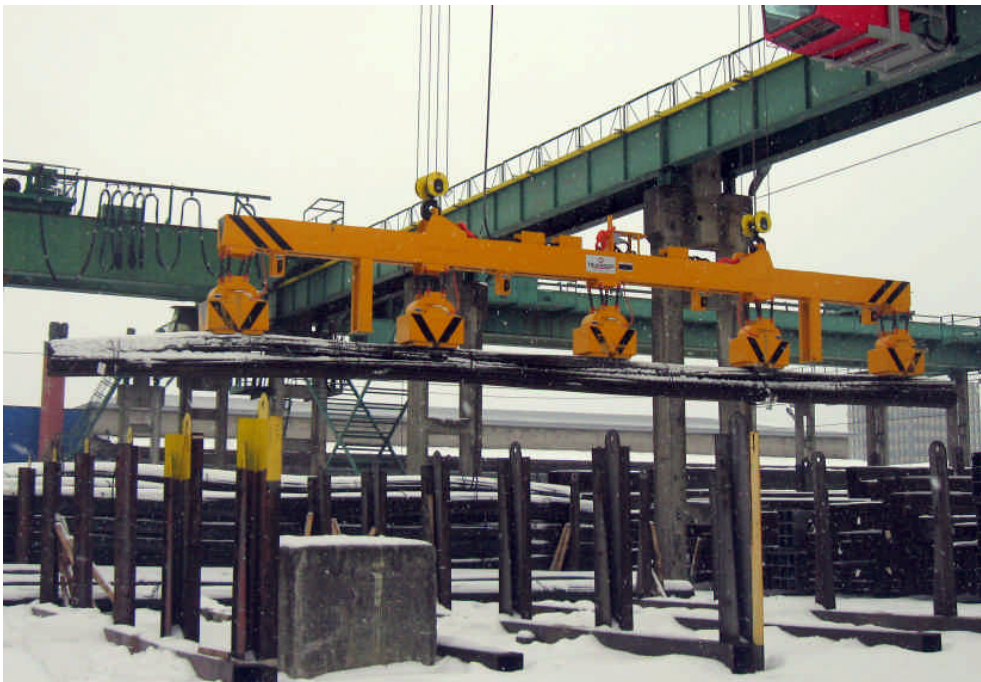
Figure 1: Umschlag von Betonstabstahlbunde im baltischen Winter
