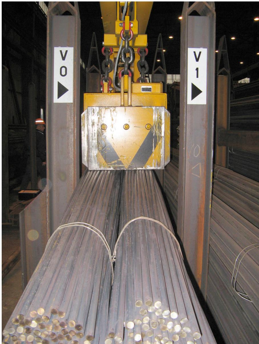
Figure 1: Lagerung der noch heissen Stabstahlbunde im Rungenlager
