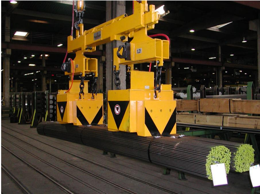
Figure 2: Magnettraverse für Doppelbundtransport im Stahlwerk
