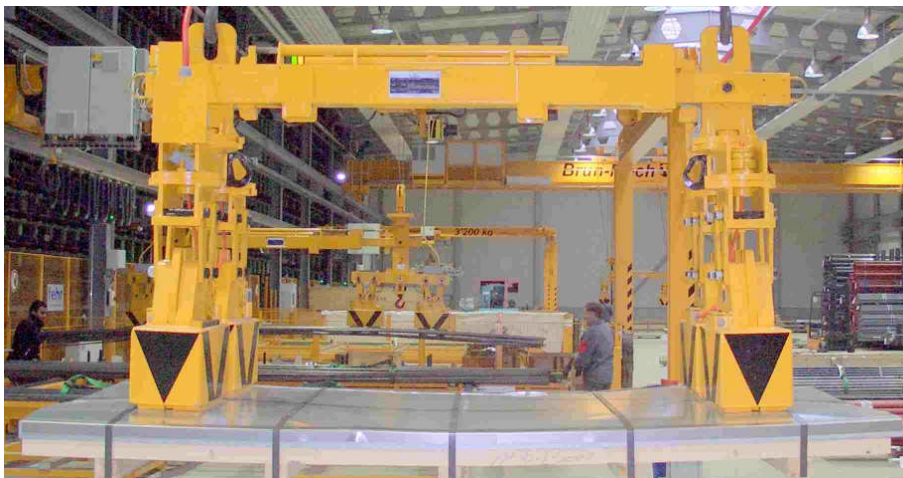
Figure 1: Um 90° gedrehte Magnete auf einem Blechpaket
