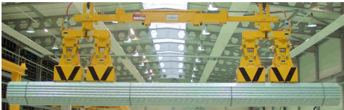
Figure 2: Magnete parallel zur Last gedreht, einen Rohrbund hebend
