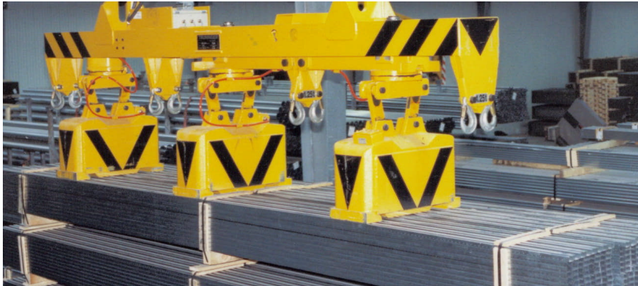
Figure 3: Drehbare Magnete heben gleichzeitig 3 Profilrohrbünde
