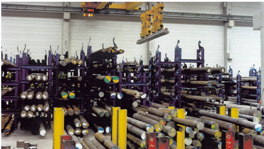
Figure 1: Ansicht eines typischen Stapeljochlagers
