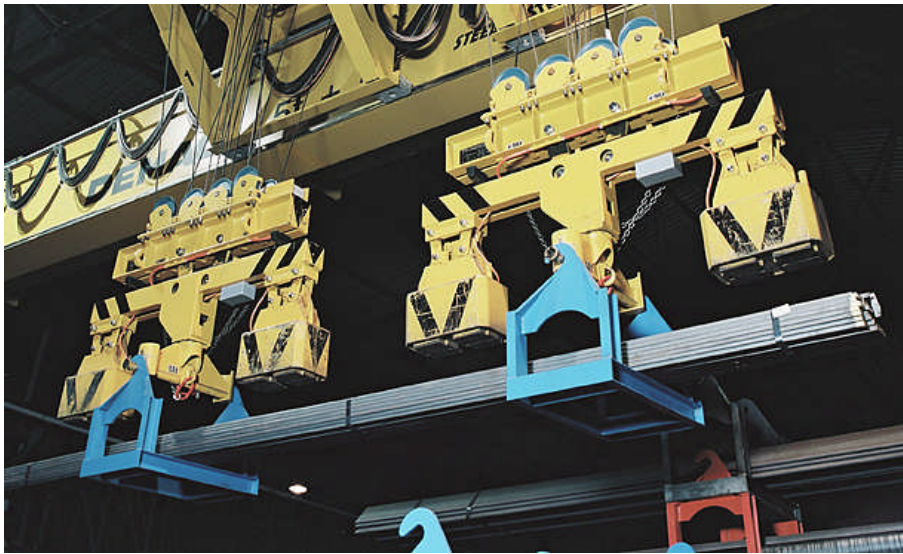
Figure 4: Jochträgertransport mit drehbaren Jochträgern
