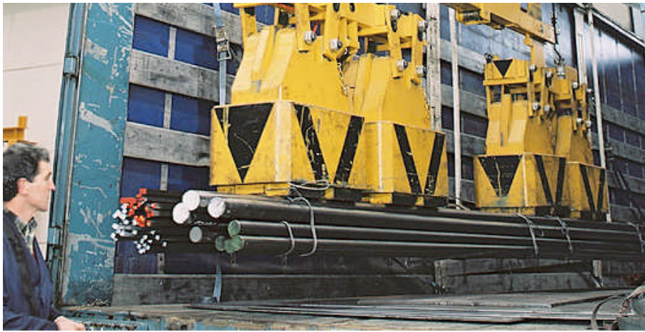
Figure 1: LKW-Entladung der Stabstahlbunde
