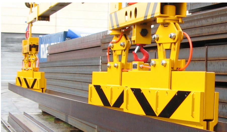
Figure 4: Drehbare Magnete auf breiten Lasten leicht schräg gestellt
