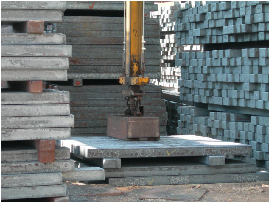
Figure 2: Lagenweiser Abtransport der dicht gestapelten und warmen Knüppel in den Stossofen
