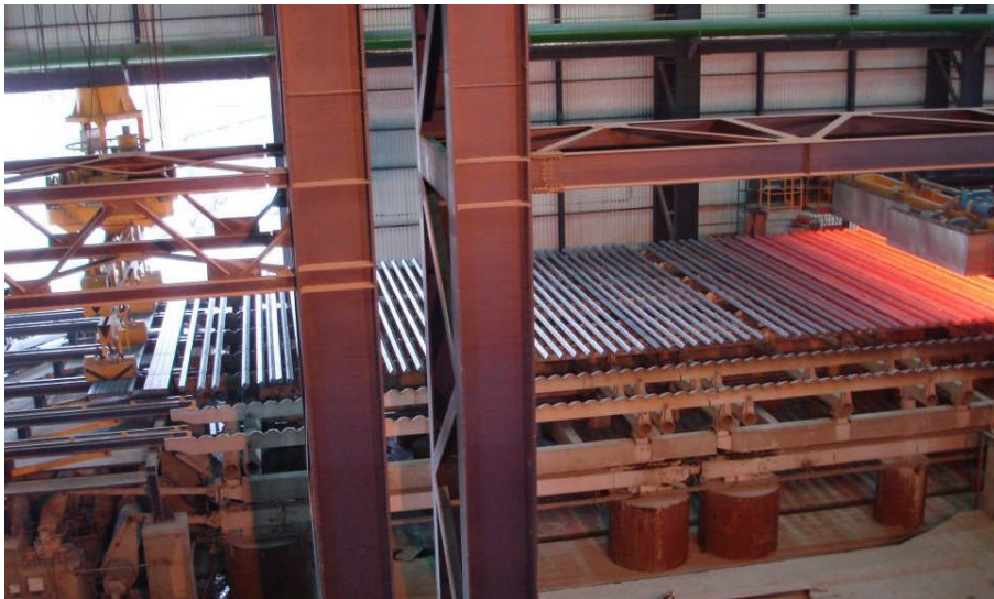
Figure 1: Heisse Knüppel auf dem Klinkenschlepper und lagenweisen Abtransport durch die Magnetanlage
