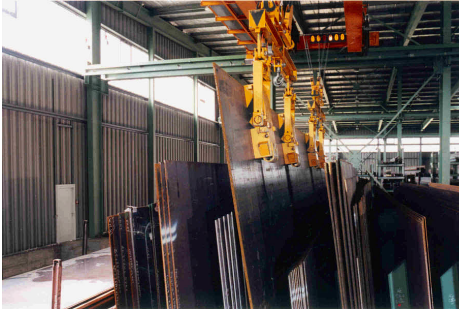
Figure 3: Grobblechentnahme aus einem Stehblechlager mit zwei unabhängigen Magnetgruppen
