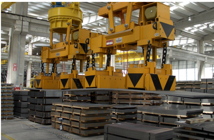
Figure 4: Transport von mehreren langen, dünnen Blechen in einem Lager mit Kompaktlagerung
