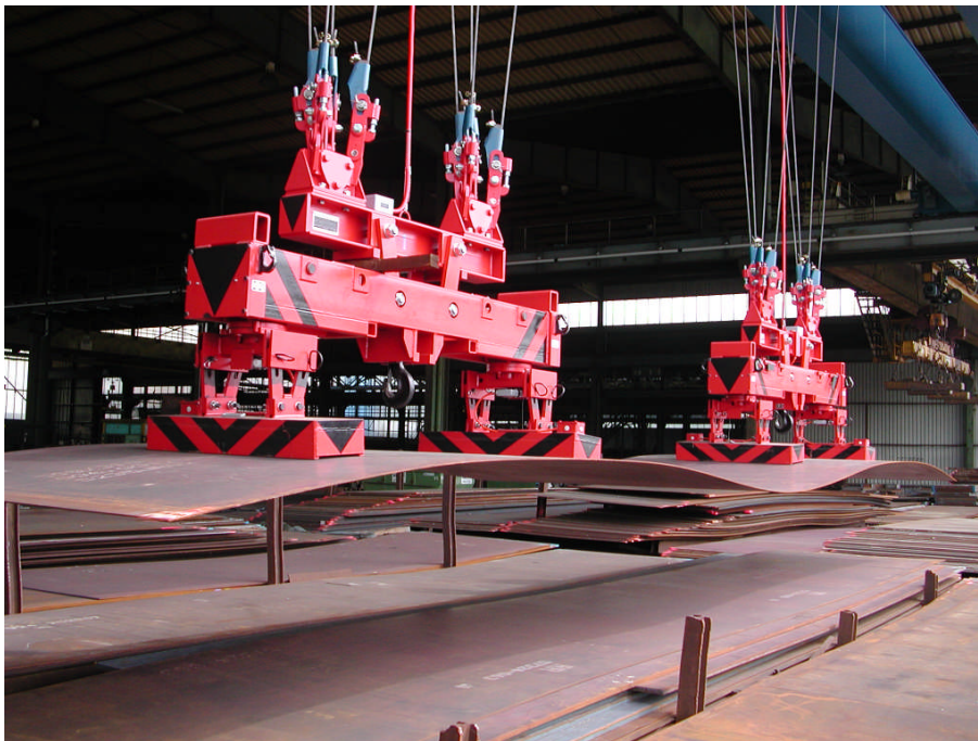
Figure 2: Grobblechtransport mit zwei unabhängigen Einzeltraversen
