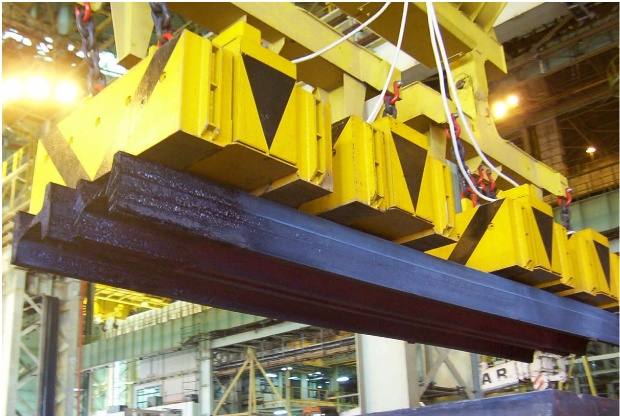
Figure 1: Umschlagen von 600°C heißen und 45 t schweren Lagen von Beam Blanks bei Gerdau Açominas SA in Ouro Branco
