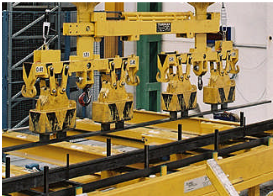
Figure 3: Kommissionieren eines Flachstabes mit den Schiebankern
